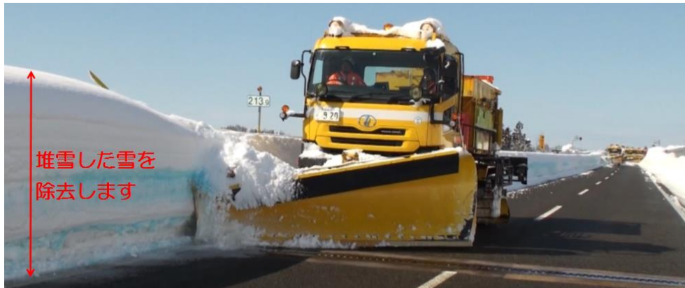
(雪堤の除去作業イメージ)
