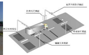
（右）自動重量計測装置による取締イメージ
