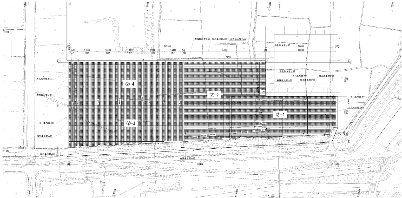
軟弱地盤対策工 縮尺 1:1000 ②工区 水平ドレーン配置計画図
