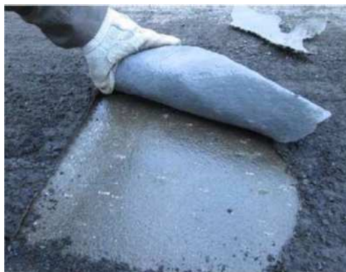
写真－2. 1 防水層の損傷事例
