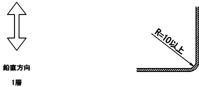
アラミド繊維シート施工接着方向 隅角部
