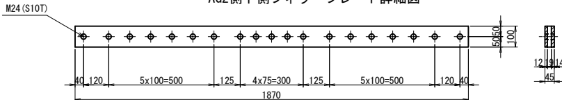
AG2側下側フィラープレート詳細図
