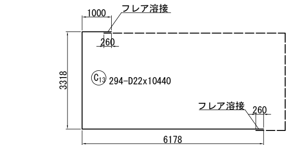
フレア溶接詳細図
