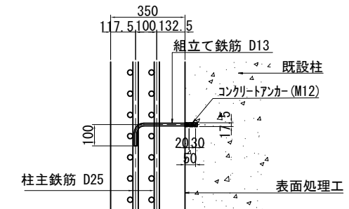
組立てアンカー参考図 S=1:25
