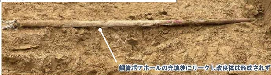
⑩特殊水ガラス系注入材溶液型（設計量）※⑨は閉塞により注入未実施
