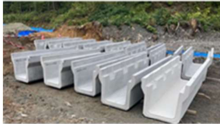
工場排ガスを養生に用いることでCO 2 をコンクリート内に固定した製品 国土交通省土木工事の脱炭素化アクションプラン（概要版）より
