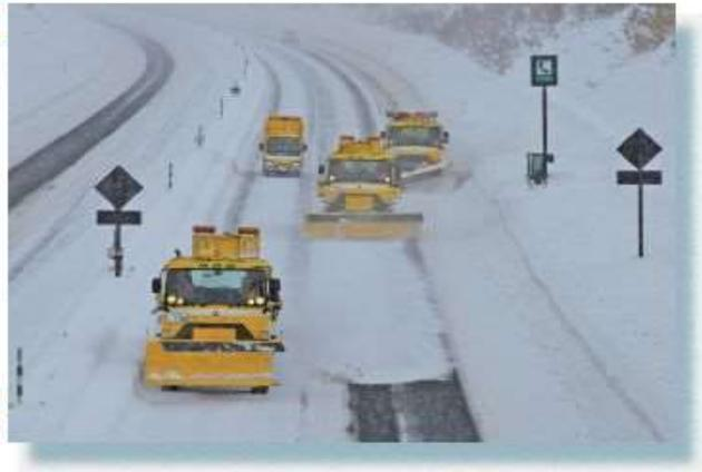
除雪トラックを3台組み合わせて低速走行しながら除雪します。
