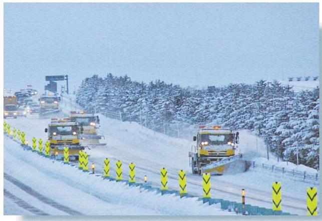
除雪トラックを4台組み合わせて除雪します。
