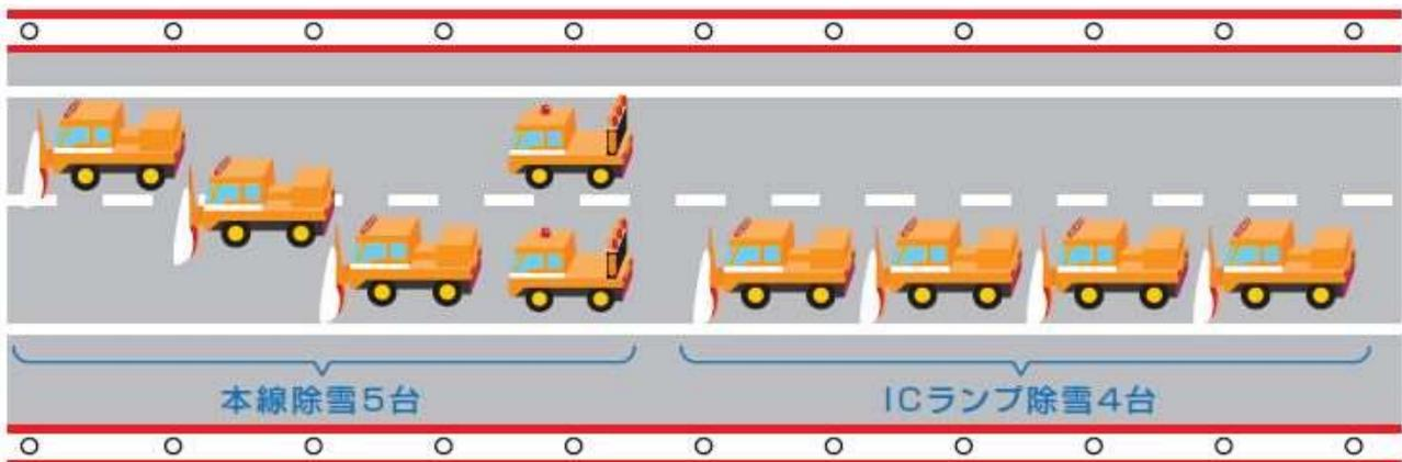
除雪車7台+標識車2台で作業します。一般除雪より作業速度が向上します。
