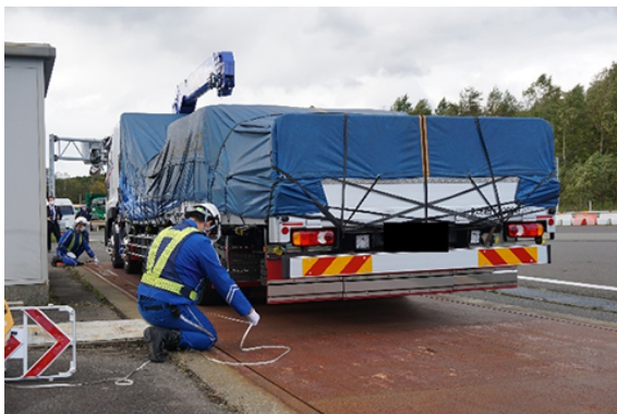
車長・重量計測の様子
