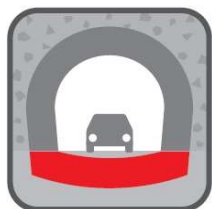
インバート（トンネル底面の逆アーチに仕上げられた覆工部分）の設置
