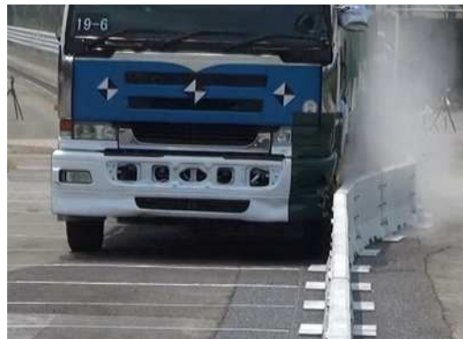
センターブロック大型車衝突実験状況
