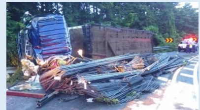
【特殊車両の重大事故事例】 無許可のセミトレーラ横転により、積荷が落下。約12時間の国道が通行止めとなった上、ガードレールや照明灯も損傷。
