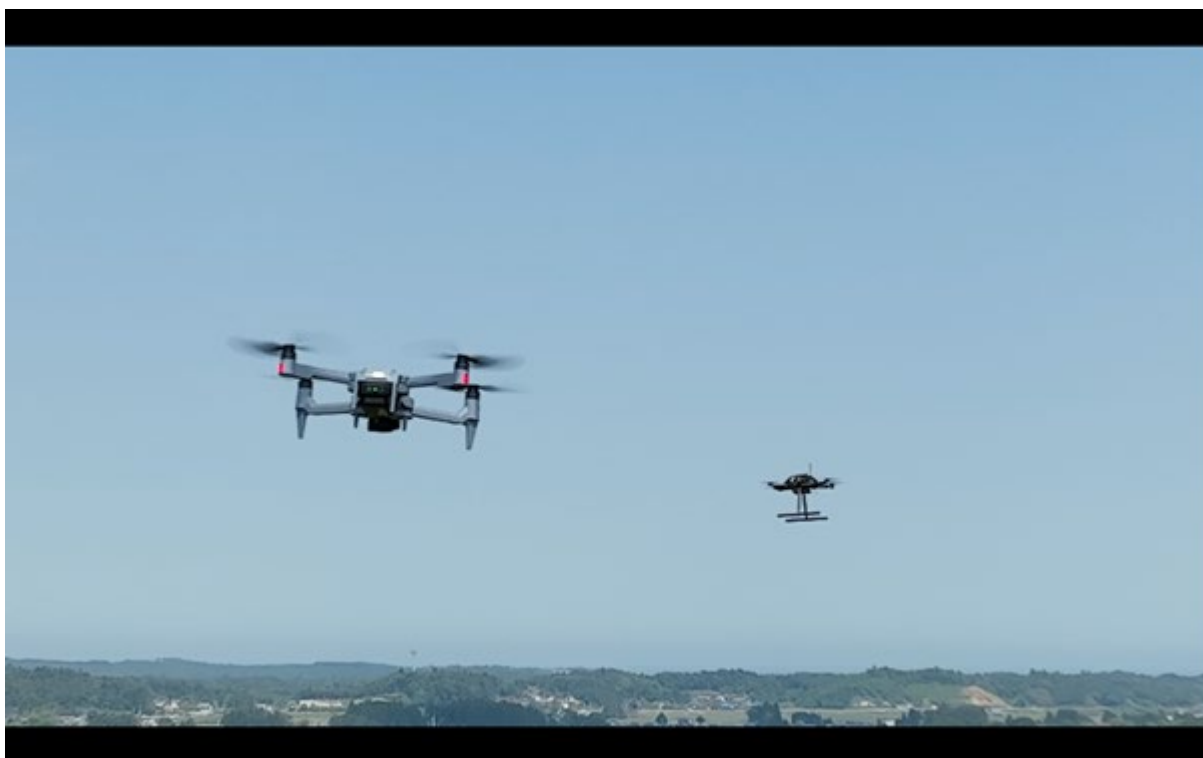
自動飛行中(右側奥)のドローンが別のドローン(左側手前)を衝突回避する様子
