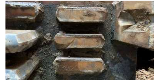
カッタービット 【地山の土を削る部材】
