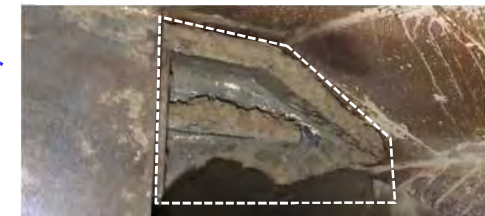
攪拌翼 【チャンバー内に取り込んだ土砂等をほぐす部材】
