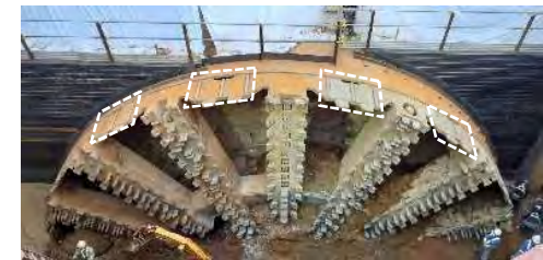
外周リング保護ビット 【外周リングを保護する部材】
