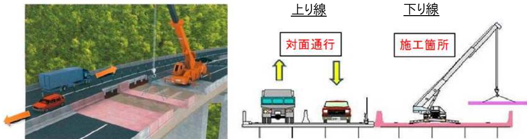
終日対面通行規制時の床版取替工事
