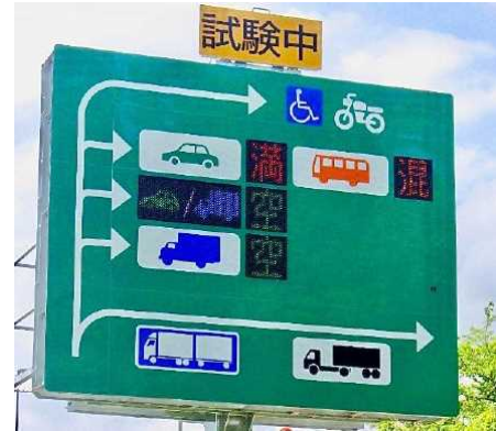
駐車状況のリアルタイム案内標識
