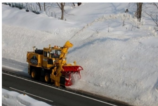
本線走行試験の様子
