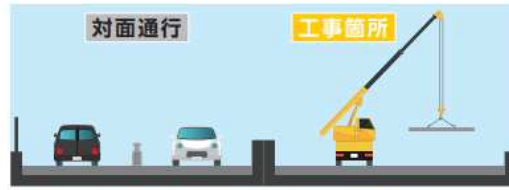
通行止めをおこなわず両方向の通行を確保する対面通行規制など、可能な限り交通への影響を抑えられる工事方法を実施していきます。
