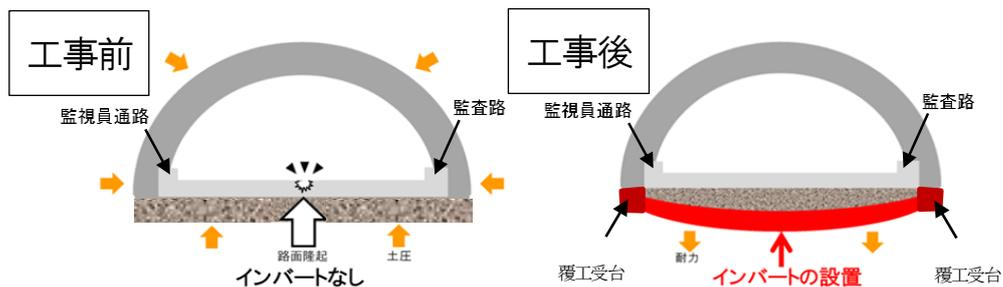
※インバートとは…トンネル底面をコンクリートにより逆アーチに結合するもので、耐力を増価させ、沈下・変状を防止します
