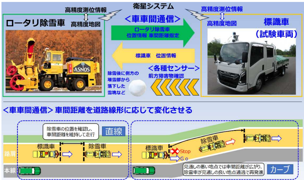
【ロータリ除雪車に追従する標識車の自動走行の開発概要】
