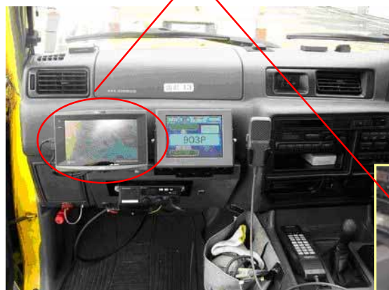
道路管理用車両への取り付け状況
