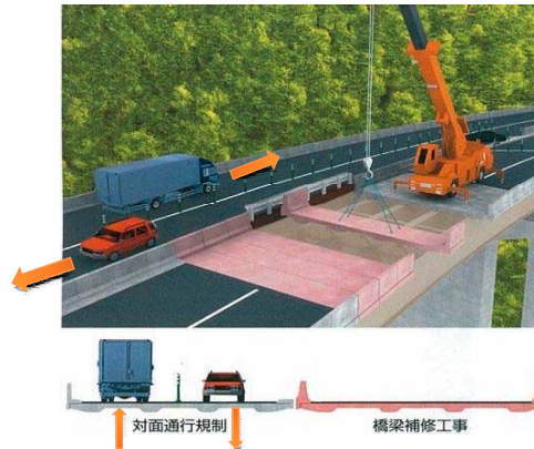
床版取替え工事のイメージ
