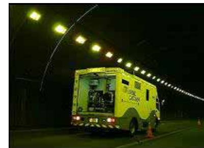
《高速クラック計測車による計測状況》
