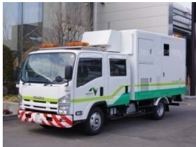
▲路面性状測定 高速走行でレーザー光線を投射し、路面のわだち掘れ・平坦性を調査
