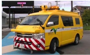
▲施設多機能測定 ETO設備・ハイウェイラジオ等の電界強度、道路照明等の照度等を測定
