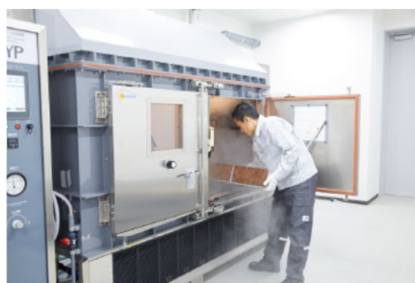
腐食促進試験機(左)、低温恒湿試験機(右)による雪氷技術の研究
