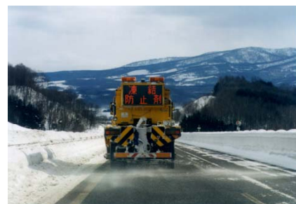
凍結防止剤散布作業車
