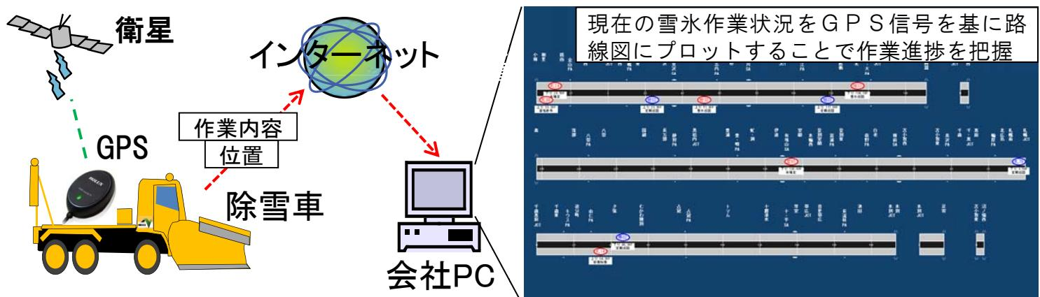
■除雪作業と本線情報板イベントの自動連動化によるリアルタイムな情報提供
