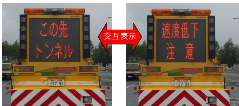
標識車によるトンネル手前の速度低下注意喚起
