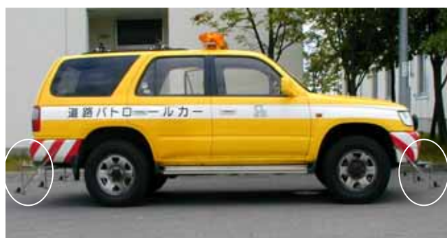
車載式照度測定装置の外観
