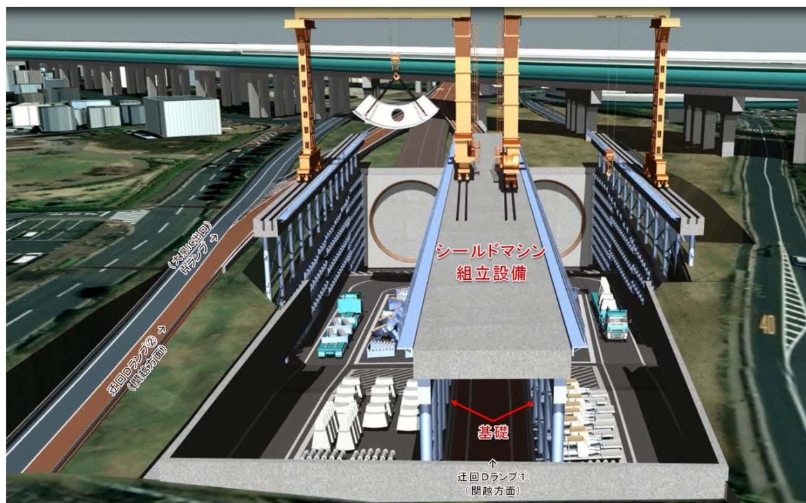
【シールドマシン組立設備概念図】
