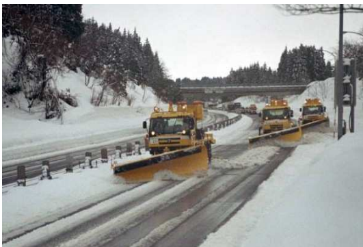
除雪トラックによる車線新雪除雪
