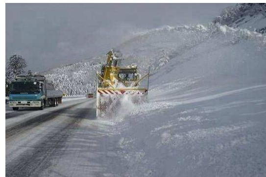
ロータリー車による路肩拡幅除雪
