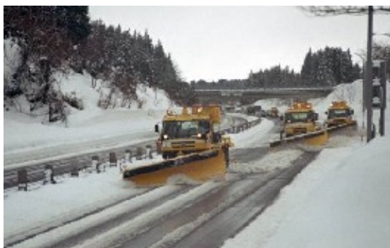
除雪トラックによる車線新雪除雪
