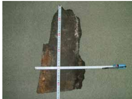
落下片 最大約 60 c m × 約 30 c m × 2.3 c m 重量 3.3 K g
