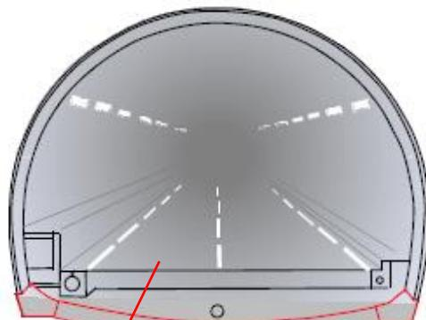
下部コンクリートの新設、舗装路面の損傷補修
