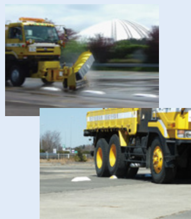
2. 除雪車による衝突実験を実施
