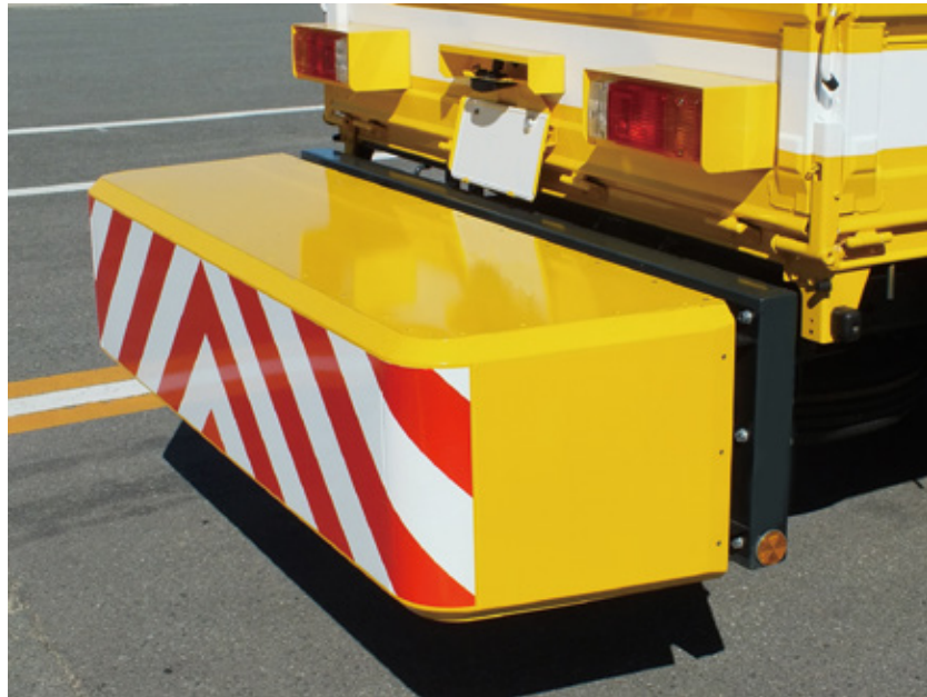
衝撃吸収能力を高める8の字構造
