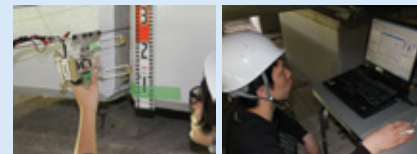
打音装置による打音測定 (※1)
