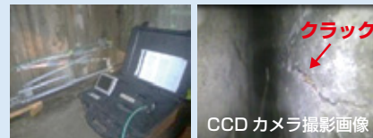
自然電位測定装置と移動システム
