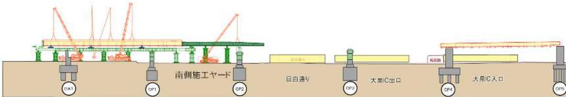
STEP2 橋桁を「南側施工ヤード」より送り出し架設します。
