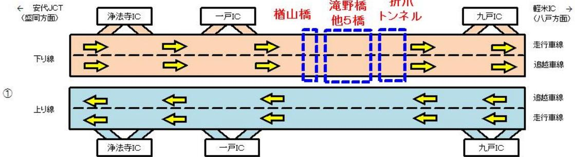
■ ステップ① 終日追越車線規制(上り線・下り線).....車線分離標設置・渡り線設置
