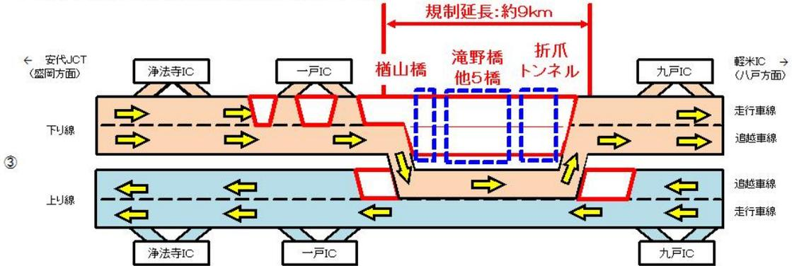
■ ステップ③ 終日追越車線規制(上り線・下り線).....渡り線撤去・車線分離標撤去
