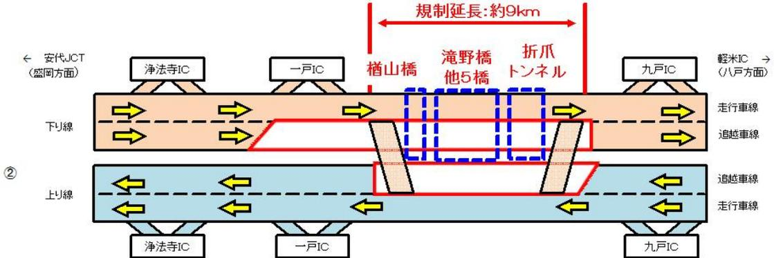
■ ステップ② 終日対面通行規制(上り線・下り線).....本体工事
